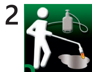
2 Feuchtigkeit mit dem Gasbrenner beseitigen
