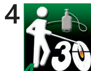
4 PREMARK® mit dem Gasbrenner fixieren
